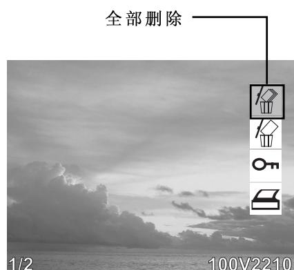
消除所有文件（照片和视频剪辑）后，LCD 屏幕上会显示“NO IMAGE”（无图像）信息。
